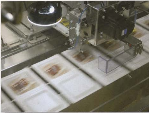
4 これは納豆菌をスプレーした煮豆が、容器に充填(じゅうてん)されるライン。煮豆が盛りつけられるとその上にフィルムが置かれ、タレとからしが乗せられる
